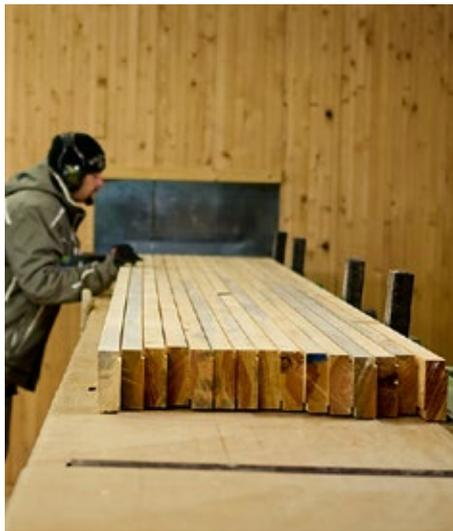
Nach dem Verdübeln wird der fertige Dübelholz-Rohling gehobelt. So entsteht ein maßhaltiges Element, bei Bedarf mit einer ebenen Sichtoberfläche. Anschließend werden bei sichtbaren Elementen große Harzgallen und Ausfalläste ausgebessert.
