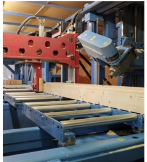
Nahezu alle Bearbeitungen können durch die CNC-Abbundanlage mit höchster Präzision ausgeführt werden. Durch ein 6-Achs-Aggregat mit Werkzeugwechsler können alle Bauteilseiten bearbeitet werden. Kabelschlitze, Leuchtenfräsungen, Auflagerausklinkungen oder Schubkerven für Holz-Beton-Verbunddecken gehören zu den Standardbearbeitungen.
